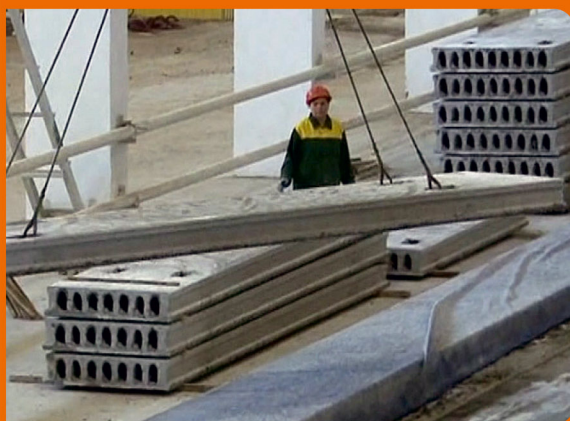
Плита перекрытия высотой от 160 до 400мм, длиной до 12 м
