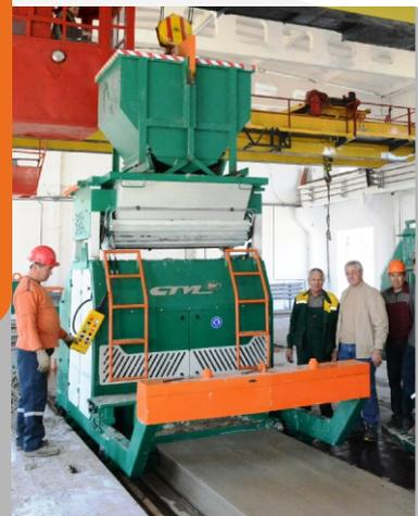
Установка бункера-наполнителя на формирующую машину
